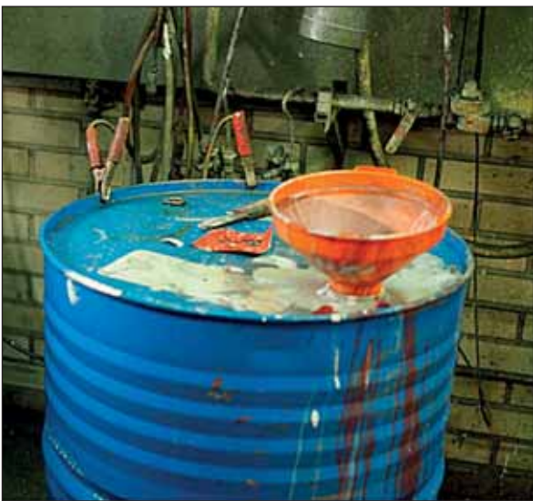
Kuva 2: Kuvassa samanlainen, kuin räjähtänyt tynnyri, sekä lisämaadoitusta varten käytössä olleet maadoitusjohdot ja puristimet.
