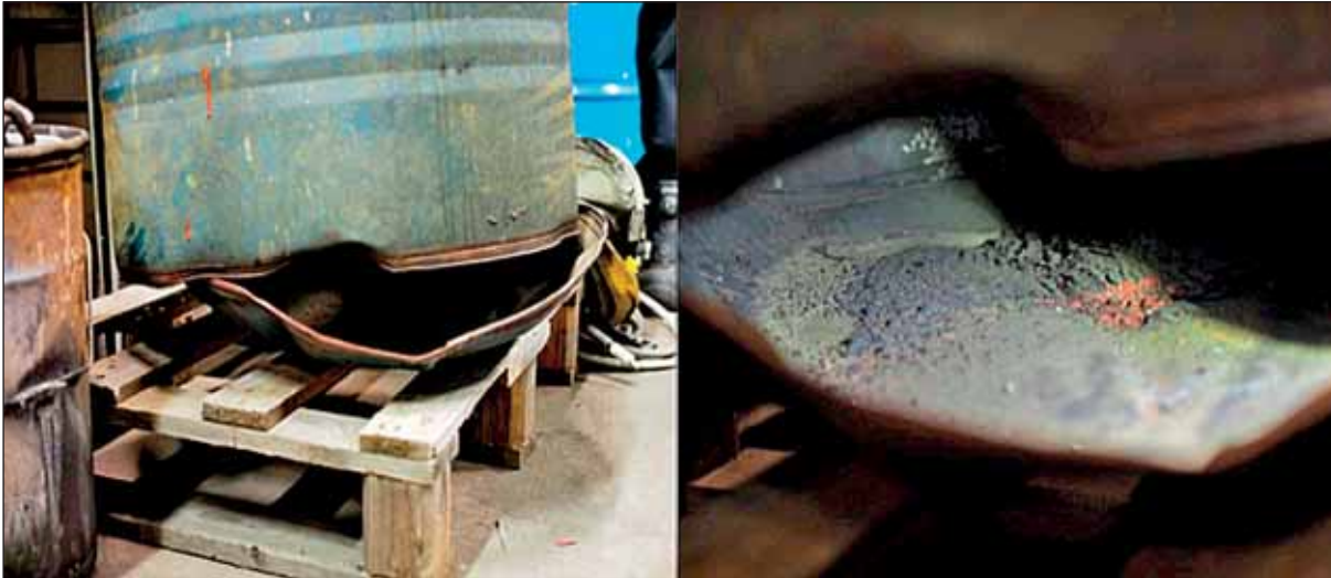
Kuva 4. Räjähätäneen tynnyrin pohja oli revennyt auki. Tynnyrin pohjalla oli hiillostuneena liuottimen palamisjäljet.
