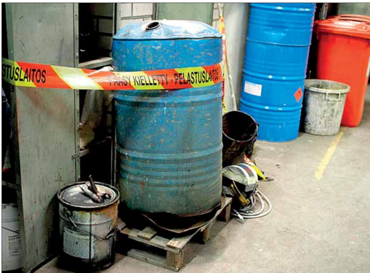
Kuva 3. Räjähtänyt maalijätteille tarkoitettu tynnyri, joka oli aiemmin sisältänyt epoksihennettä (OH 17).
